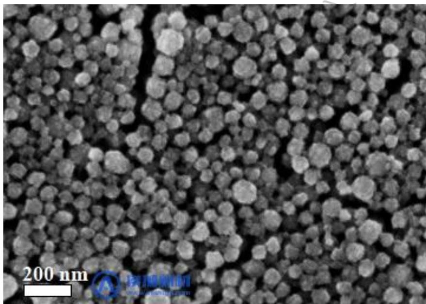
图 1 普鲁士蓝纳米颗粒的扫描电镜图
