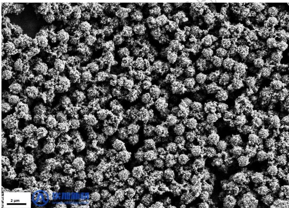
图 1 链霉亲和素磁珠的扫描电镜图
