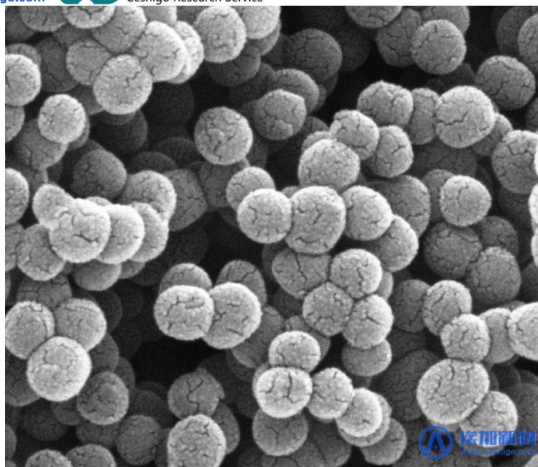
图 2 氮掺杂介孔碳 (130-170nm) 的扫描电镜图
