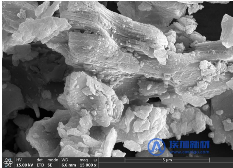
图 1 钛碳化铝(Ti 3 AlC 2 ) MAX 的 SEM 图
